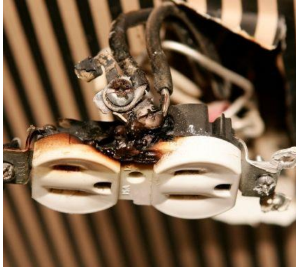
Photo F1 – Failure of aluminum wiring terminations
